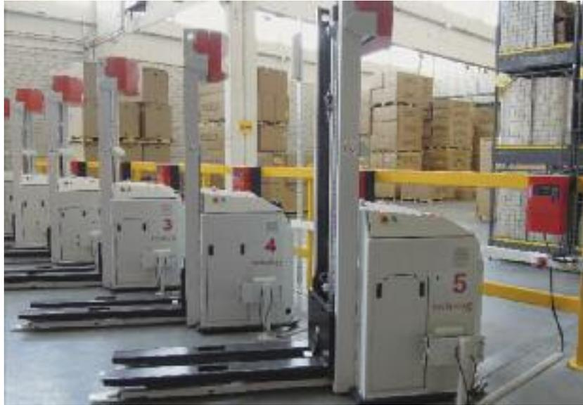
Lasergesteuerte Stapler im AMAG Zentralersatzteillager
