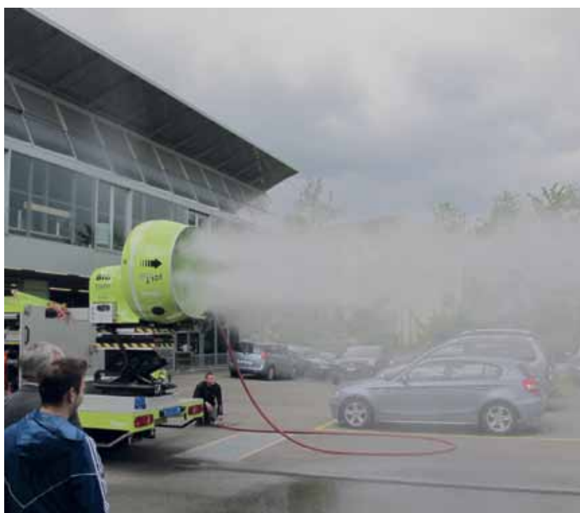
Brandlüfter mit Wassereinspeisung
